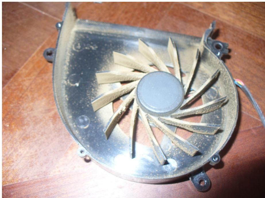
**Remède** : nettoyer les pales avec des cotons tiges humides en bloquant la partie ronde du centre sans tordre l'axe, le support du ventilateur ; souffler le radiateur, les composants, le clavier avec un petit compresseur, changer la pâte thermique du processeur et de la carte graphique.
